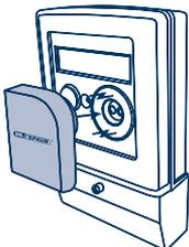
2. EcoTracker magnetisch an die optische Schnittstelle befestigen. USB-Buchse nach unten und Netzeil an eine Stromquelle anschließen.
